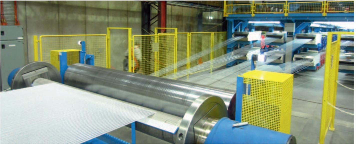
Elektrische Einzelseilspannungstation mit Rollenkamm
