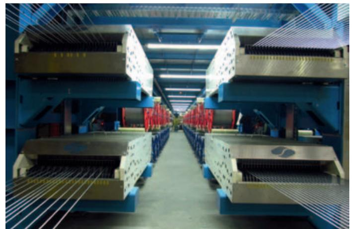
... Messboxen für die Seilspannung
